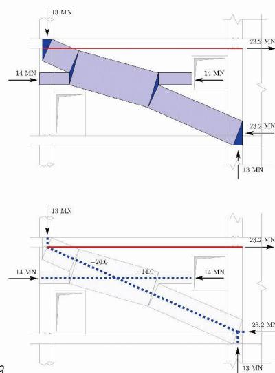
Fig. 10 : Modèle de champ de contraintes avec appui indirect et modèle de bielles-et-tirants équivalent, charge vers le bas, forces de dimensionnement en MN
