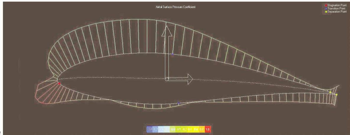
Fig. 1 : Coefficients de pression sur la surface d'une aile
