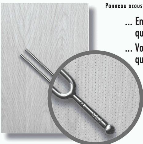
La surface de cet élément en bois reflète l'attention par les très petits trous, d'un diamètre de seulement 0,5 mm. La micro perforation est à peine visible, même à courte distance. RONDOL® avec une surface ouverte de seulement 5,7%, atteint effectivement, une incroyable absorption de sons. Le coefficient NRC d'absorption de sonorité, correspond au chiffre formidable de 0,8.
