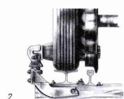
*Fig. 1 : Éléments constitutifs de la voie : (1) traverse bi-bloc, modèles long (avec support isolateurs) et court (simple); (2) chausson anti-vibratile, par bloclet; (3) rail classique (ou Vignole) avec semelle anti-vibration; (4) piste de roulement avec semelle anti-vibration; (5) barre de guidage et d'alimentation; (6) isolateur-support; (7) béton de calage*
