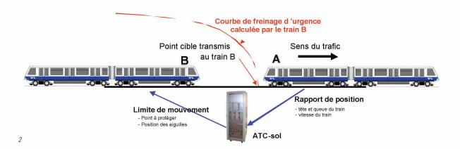
performance et est une fonction mise en œuvre par l'ATP, l'arrêt précis en station, mis en œuvre par l'ATO et la régulation des trains qui garantit au passager la qualité de service (disponibilité) et est prise en compte par l'ATS.
