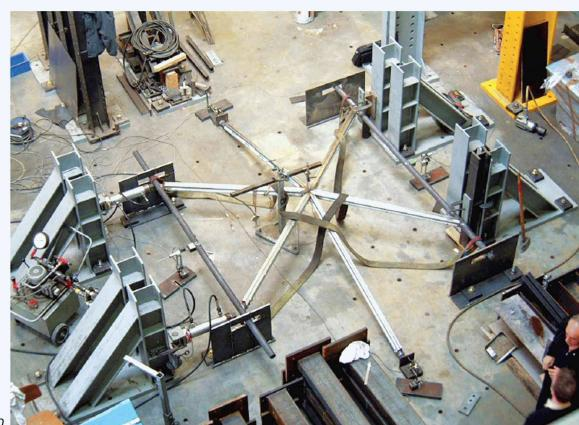
durant laquelle on a observé que, sous une charge de 200 kN, les extrémités des tubes proches du nœud s'ovalisaient et les caches en inox se déformaient.
