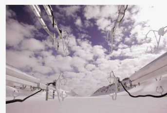
Anémomètres soniques faisant face à l'étendue du glacier de la Plaine Morte (©Jako Martinet)
