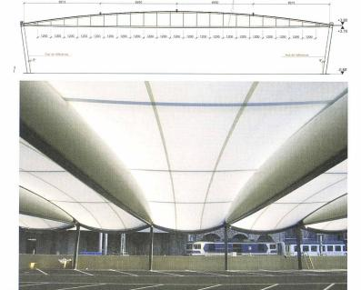
Fig. 1: Elévation d'une poutre Tensairity
