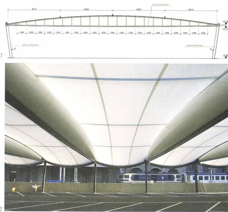
Fig. 1 : Elévation d'une poutre Tensairity
