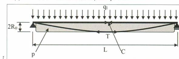
Plus les tubes seront élancés, plus les deux câbles en spirale seront parallèles à l'axe du tube même. Compte tenu de la pression des câbles sur la membrane, celle-ci va se déformer en deux arcs de cercle, conduisant à la formation de deux cylindres de rayon  $R$  (fig. 2).
