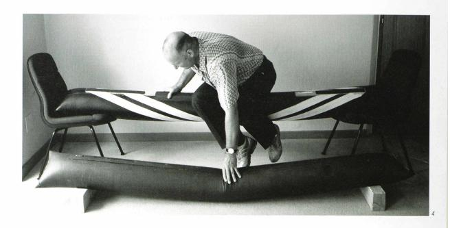
La figure 4 montre un de mes premiers prototypes. Les deux tubes ont une même pression d'environ 200 mbar. L'élément en compression est simplement constitué d'une fine latte en bois de 5 x 40 mm. La spirale est un ruban en tissu plastique, collé aux extrémités de la latte en bois.
