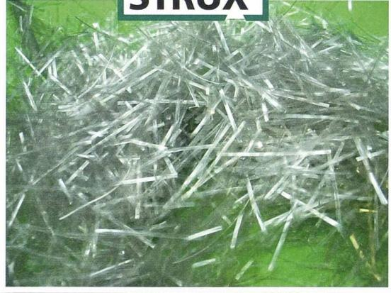
**Pour le renforcement des bétons,
