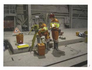
réticule du tachéomètre est mis en coïncidence avec son image dans le miroir, permettant ainsi un doublement de la précision par rapport à des mesures de direction conventionnelles.
