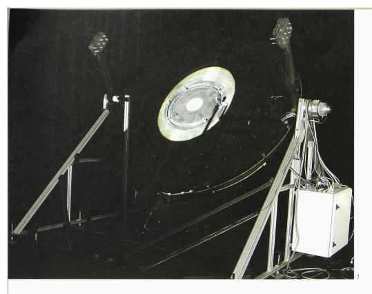
afin d'être détectée par la caméra CCD (fig. 2b). Ainsi, après six rotations de 60° de l'écran et de la caméra, toute la distribution de lumière aura été détectée et sera donc connue, moyennant une série de calibrages et traitements de données appropriés.
