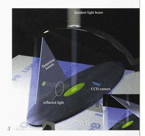
Fig. 1 : Goniophotomètre bidirectionnel à imagerie numérique développé au LESO-PB de l'EPFL, dispositif expérimental
