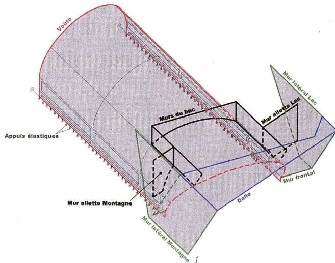
Le système du bac exige en outre que la structure sorte au devant de la paroi rocheuse, tout en restant indépendante des ponts qui ne peuvent reprendre aucune charge supplémentaire et dont le déplacement horizontal dû aux variations de température doit demeurer libre. Cette situation a conduit à choisir une structure en porte-à-faux encastrée dans la paroi rocheuse.
