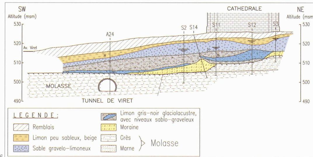
Fig. 6 : Profil hydrogéologique et situation du tunnel Viret par rapport à la Cathédrale
