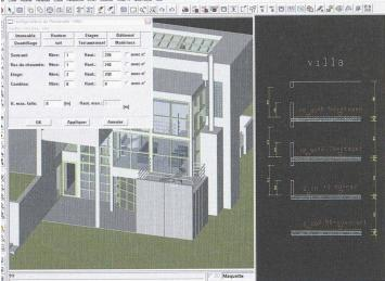
EliteCAD permet au projeteur d'utiliser la technique raditionnelle du plan 2D, ainsi que les avantages de la nodélisation 3D directe pour obtenir rapidement des coupes, respectives et façades.
