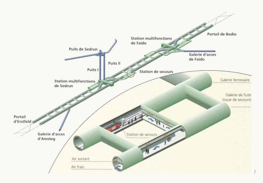
Cette option assure non seulement un niveau de sécurité accru grâce à une meilleure séparation de l'air frais et vicié, mais aussi l'abandon de la paroi de division dans le premier puits, permettant une exploitation logistique optimale de ses huit mètres de diamètre.
