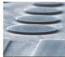
Cavités à microdisques contenant en leur centre une « boîte quantique » (Document Valéry Zwiller, ETHZ; montage Atelier Poisson)
