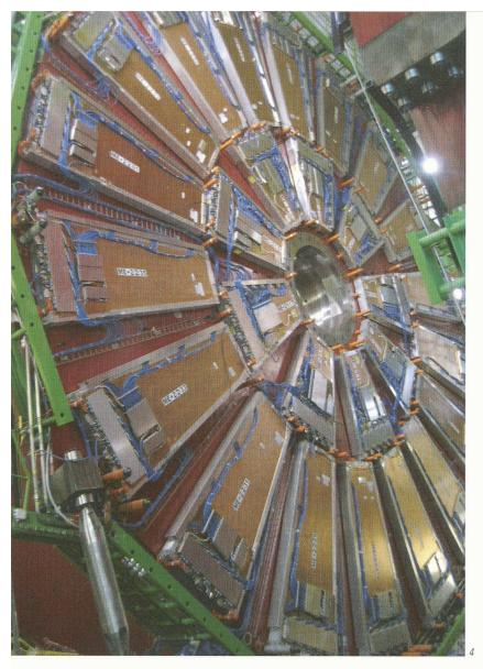
« camembert » de 35 tonnes à droite, puis à gauche (fig. 4). Toutes les sections individuelles du baril et des bouchons sont supportées par des patins à air d'une capacité de 250 ou 385 tonnes, ce qui permet un déplacement aisé de tous les éléments lourds.
