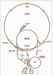
Fig. 1 : Schéma des accélérateurs (Source : CERN)
