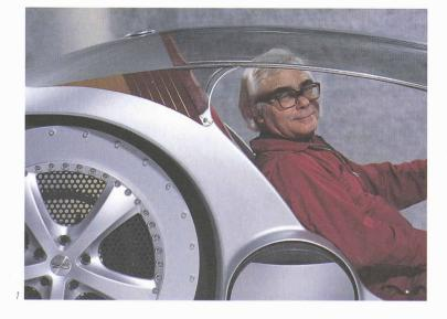
Fig. 1: Franco Sbarro au volant de son « mono trace » à deux roues, l'un des premiers véhicules conçus avec une roue motorisée, ici à l'arrière
