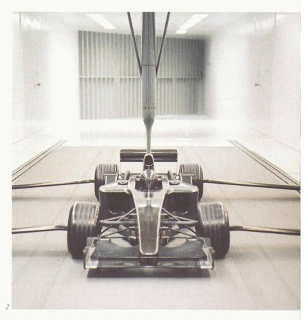
Fig. 3: Partie inférieure de la « Rolling Road », entraînée par un ruban en acier
