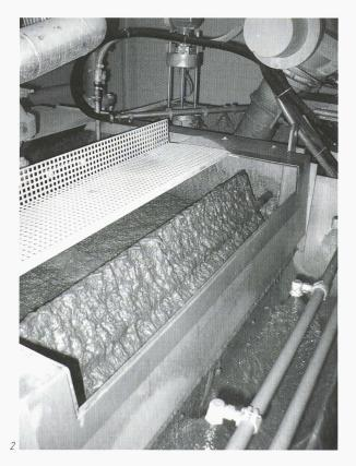
La première étape du processus consiste à débourber dans un hydrocyclone le sable issu de la préparation du gravier. La fraction la plus fine, d'une granulométrie de l'ordre de 0,060 mm, est concentrée au sommet de l'installation, puis elle est acheminée dans la centrale de traitement des eaux.
