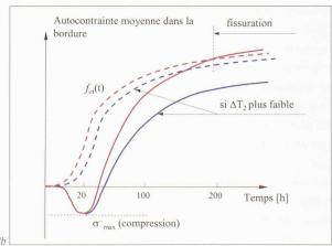
Fig. 2 : Influence de l'intensité du refroidissement sur la probabilité de fissuration, adapté de [4]
