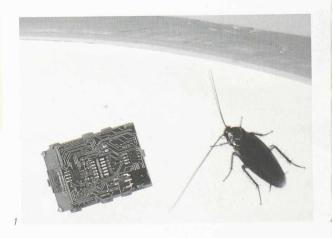
Fig. 1: InsBot : le robot imite les comportements déterminants des blattes, pour s'intégrer à une colonie, dans le but d'influencer les habitudes des insectes.
