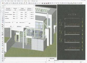
EliteCAD permet au projeteur d'utiliser la technique traditionnelle du plan 2D, ainsi que les avantages de la modélisation 3D directe pour obtenir rapidement des coupes, perspectives et façades.
