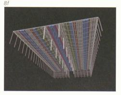
Fig. 12 : Un élément de pré-dalle. On distingue les éléments accoustiques et les rails de fixation (Photo Luc Buscarlet)
