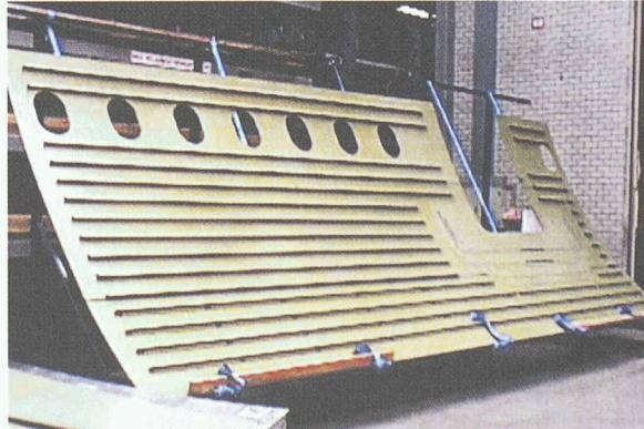
*Fig. 9: Le glare, un composite multicouche à base de fibres de verre, d'époxy et de fibres d'aluminium utilisé sur les panneaux supérieurs du fuselage (Document Daimler Chrysler Aerospace Airbus)*
