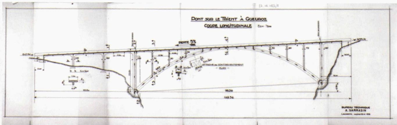
Fig. 1 : Pont du Gueuroz sur le Trient, coupe longitudinale
