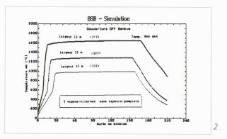
Fig. 1: Plan de situation et tronçons (Document: Ville de Genève) Fig. 2: Courbes température-temps pour cinq wagons citernes en flammes dans la galerie (Document: Geilinger)
