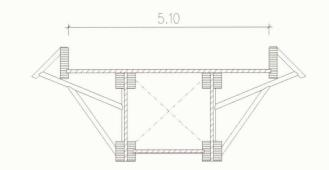
Fig. 6: Pont de Crest: assemblage des contrefiches sur les nervures du tablier et sur l'appui béton
