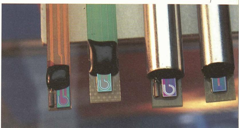
Fig. 1: La puce et les microélectrodes chargées de maintenir un potentiel électrique adéquat sont montées dans un cylindre servant de contre-électrode.
