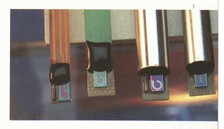
Fig. 1: La puce et les microélectrodes chargées de maintenir un potentiel électrique adéquat sont montées dans un cylindre servant de contre-électrode.
