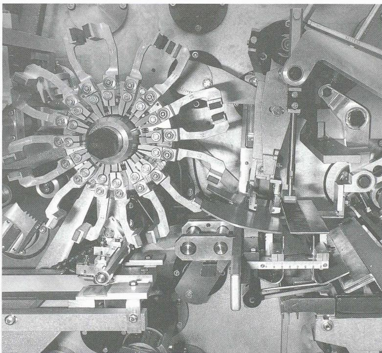
Fig. 3. – Revolver de pliage sur la MULTISTYLE, pour emballer des boules de chocolat et torsader les bouts (papillotes)
