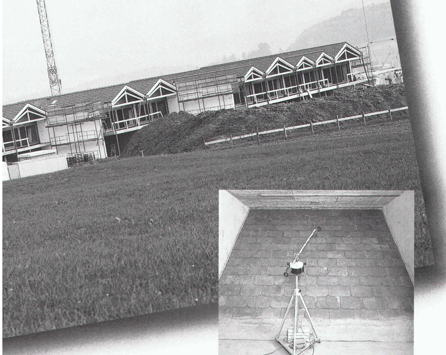
Test d'impact aux bruits aériens sur modèle réel. EMPA Zurich.
