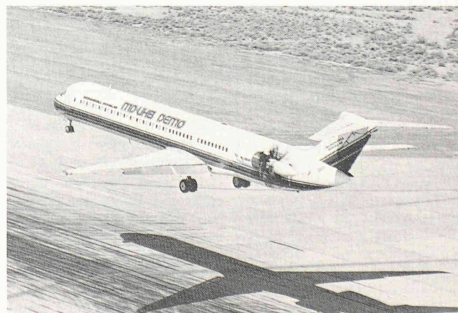
Dernière en date de la série Douglas MD-80: version destinée à l'expérimentation de nouveaux types de propulseurs dits à taux de dilution ultra-élevé.
