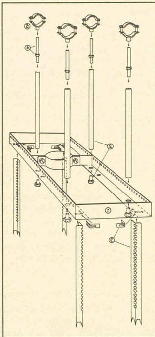
Fig. 1. - Le jeu de construction: 1. Cadre de montage. 2. Tubes-supports/vis. 3. Pieds/agraves. 4. Tiges filetées M10 avec écrous (ajustage de la hauteur). 5. Colliers pour tuyaux.
