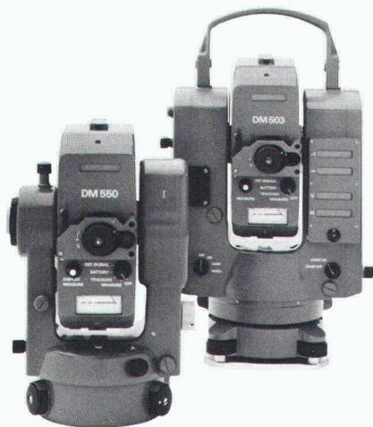
Le DM 550 mesure l'angle vertical et réduit **automatiquement** la distance mesurée à la **distance horizontale**.
