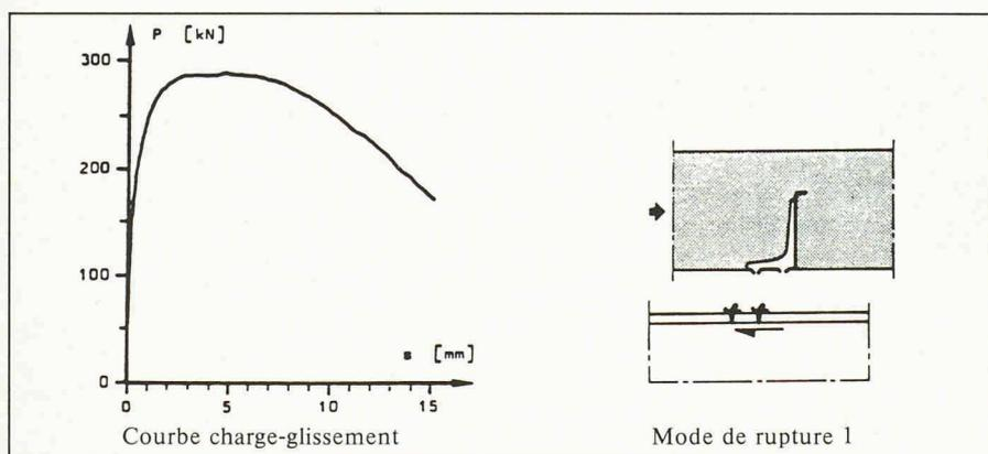
Fig. 3. — Comportement ductile.
