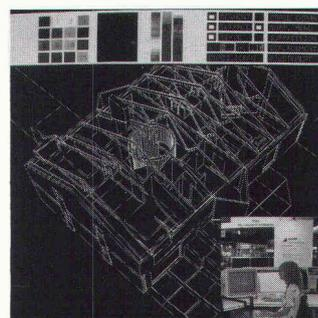
STAR (station architecture) est un système déjà utilisé dans plus de 100 bureaux d'étude. L'utilisation du programme ne nécessite aucune connaissance en informatique, la conception du bâtiment s'effectuant à l'aide du crayon électronique.
