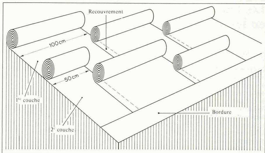
Fig. 2. — Étanchéité bitumineuse multicouche selon [3].
