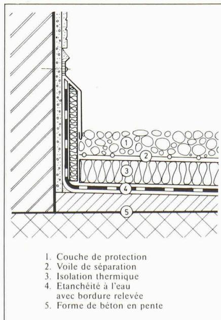
Fig. 5. — Toiture inversée et bordure relevée de l'étanchéité en LBP
