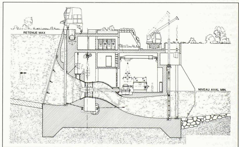
Fig. 5. — Coupe-type d'une usine avec turbine en S.
