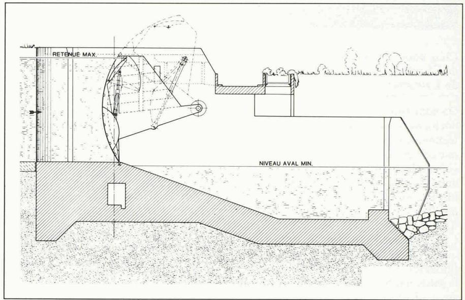
Fig. 4. — Coupe-type d'un barrage avec vanne-segment à clapet.
