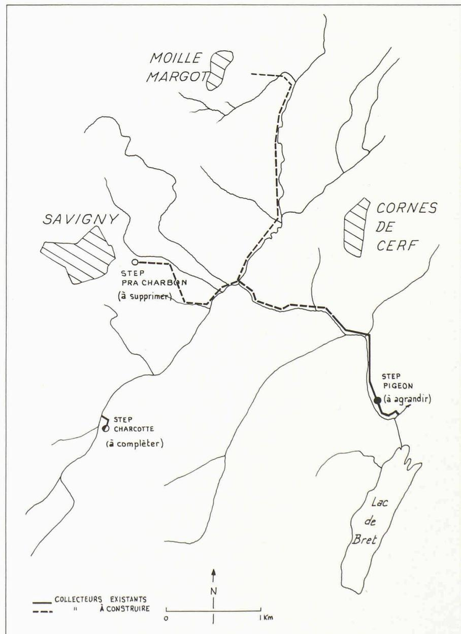
Fig. 2. — Collecteurs principaux et stations d'épuration de la variante 4.
