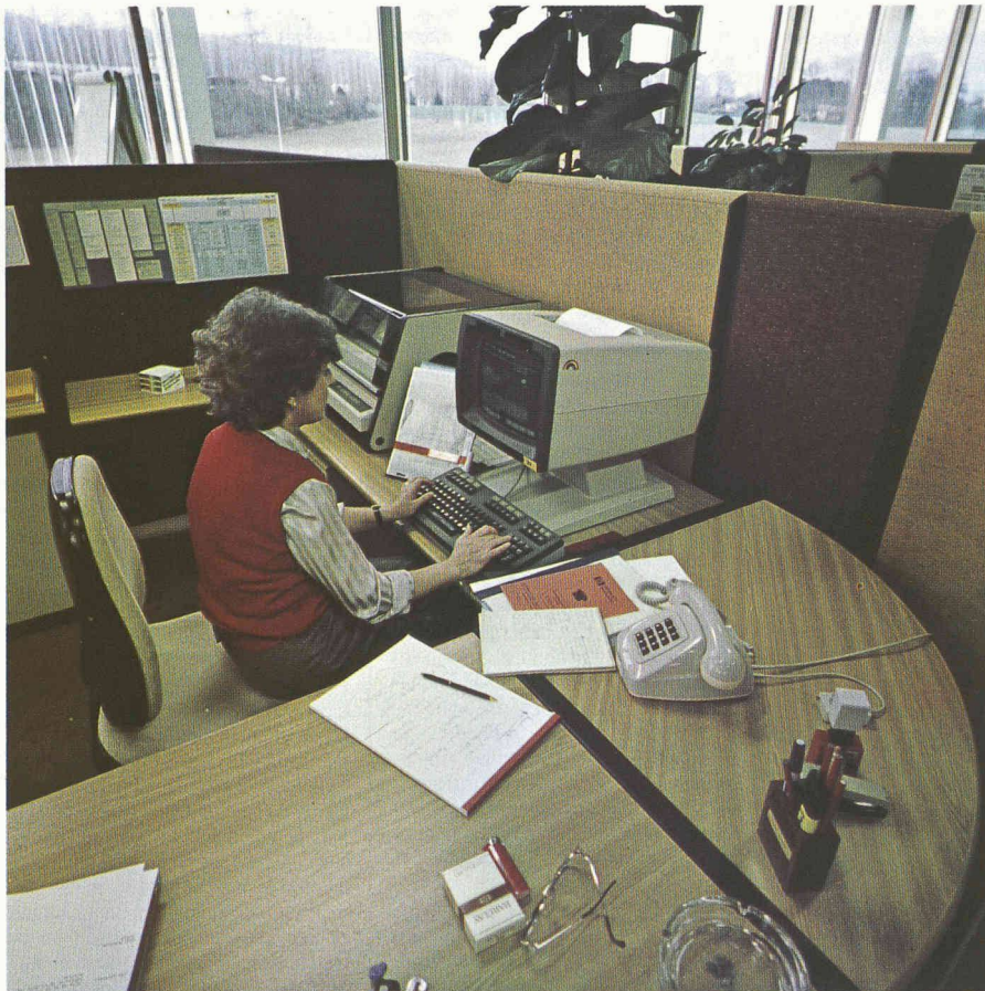
Fig. 15. — Un poste de travail du siège européen de Hewlett-Packard. Répondant à la fois aux exigences de l'informatique la plus moderne, de l'ergonomie et d'un agrément optimal du cadre, il demande un équipement important et une étude approfondie portant notamment sur l'acoustique, l'éclairage et la répartition des espaces utiles. Tous ces facteurs ont été pris en compte dans la conception du bâtiment, de même que la souplesse permettant l'adaptation à de nouveaux développements.
