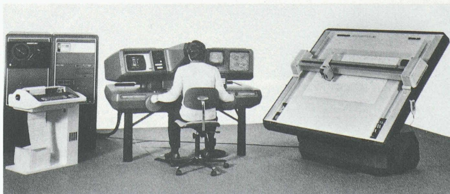
Fig. 8. — Aviolyt AC1 con Aviotab TA2 (Wild). Sistema moderno di stereorestituzione analitica, comandata da un ordinatore per tutti i lavori di restituzione nel campo della fotogrammetria.
