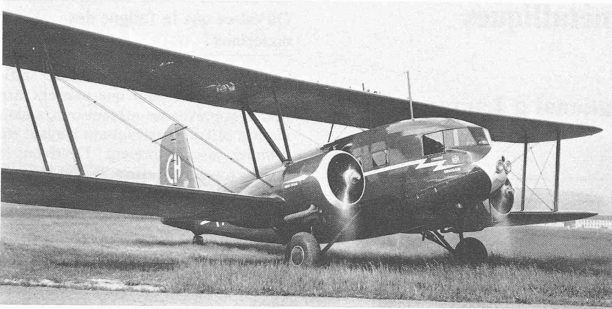
Fig. 3. — Cet avion Curtiss Condor de Swissair s'est abattu le 27 juillet 1934 près de Tuttlingen (Wurtemberg) à la suite de la rupture en fatigue d'un hauban reliant aile et moteur.
