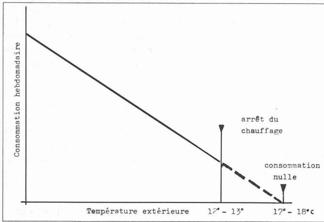
Fig. 3. — Enclenchement en fonction de la température extérieure.
