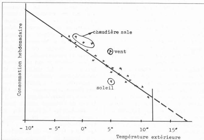
Fig. 5. — Influence d'anomalies sur le fonctionnement.
