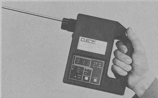
chauffe et le pourcentage d'oxygène ambiant. Il contient également les données nécessaires pour tenir compte du combustible utilisé, que ce soit le mazout, le gaz naturel ou le charbon. Des abaques donnent les valeurs pour l'air propane et le gaz de craquage, le pourcentage de CO<sub>2</sub> pour les comparaisons éventuelles et l'excès d'air insufflé.
