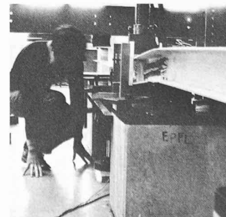
Détermination de la résistance d'une poutre métallique par un essai de charge jusqu'à la rupture, soit environ 30 tonnes (photo Foetisch).
