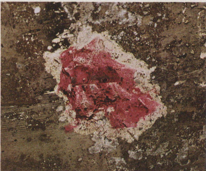
Pont B. — Le béton alcalin enrobe encore entièrement cet acier comme en témoigne sa coloration rouge.
