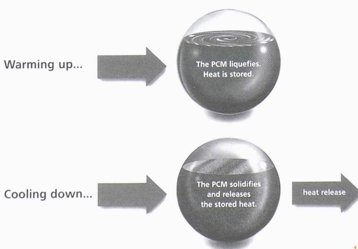
Fig. 1 : Les matériaux à changement de phase (PCM) : quand il fait chaud, les PCM encapsulés dans le tissu se liquéfient et prélèvent de la chaleur à leur environnement pour la stocker ; quand il fait froid, ils se solidifient en restituant la chaleur accumulée (Photo Schoeller).
